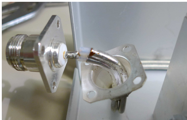
Bild 17: Ausführung des Sternpunktes bei der AFL-Duplex-Weiche
