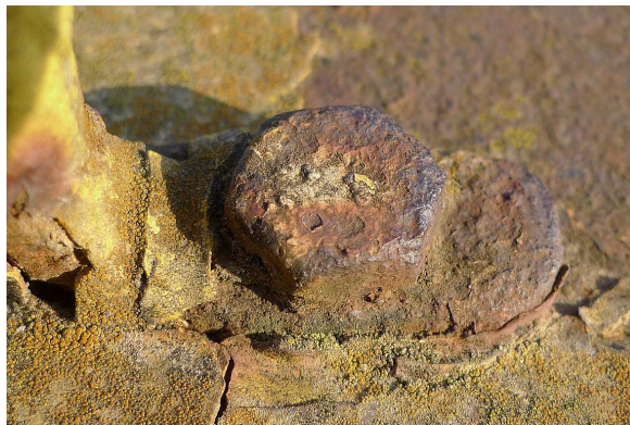
Bild 3: "rusty bolt effect" an angerosteten Schraubverbindungen
