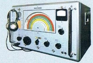
Ein Kurzwellenbetriebs- und Suchempfänger von 1956 aus Ulmer Fertigung
