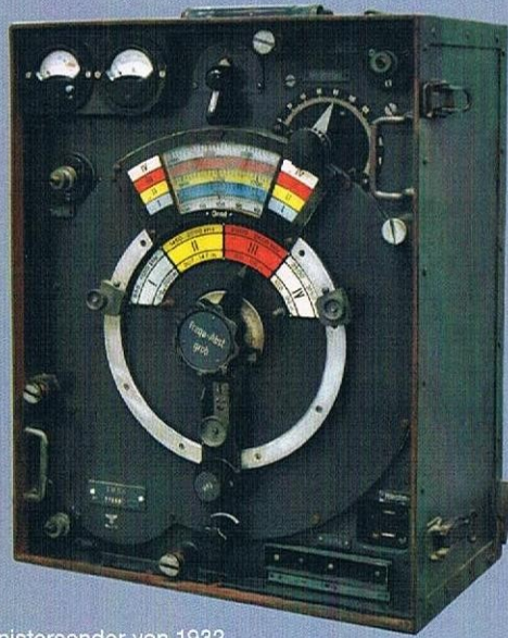
5W-Tornistersender von 1932 mit direkt geeichter Skala
