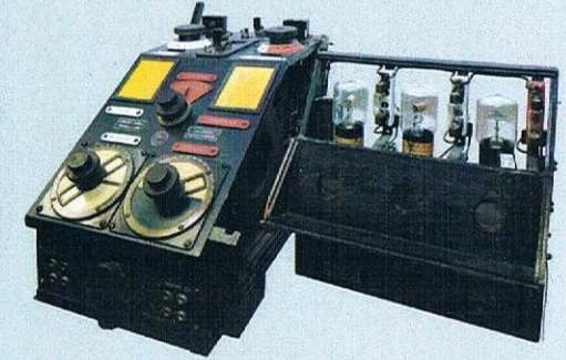
Ein Primär-Sekundär Detektorempfänger sowie ein Dreiröhren-Verstärker aus der Zeit des 1. Weltkrieges
