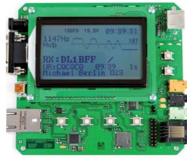
Das UP4DAR-Bord, eine universelle Plattform für digitale Betriebsarten
