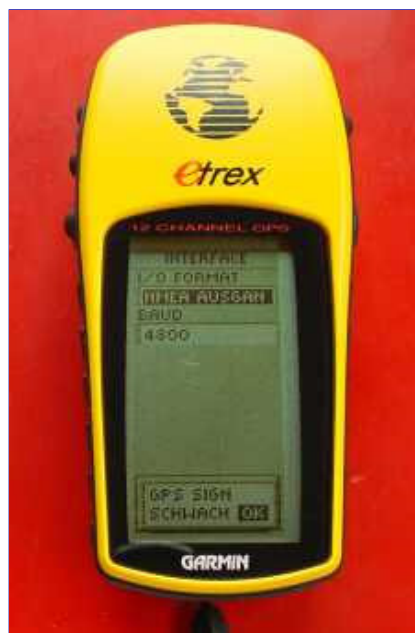
Bild 11: Die Einstellung der Schnittstelle am GPS-Empfänger Garmin E-Trex
