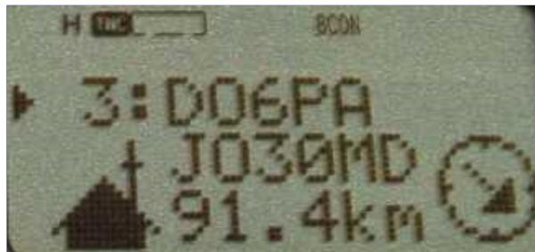
Bild 5: Das Programm im TH-D7E berechnet aus dem übermittelten Locator, Antennenrichtung und Entfernung
