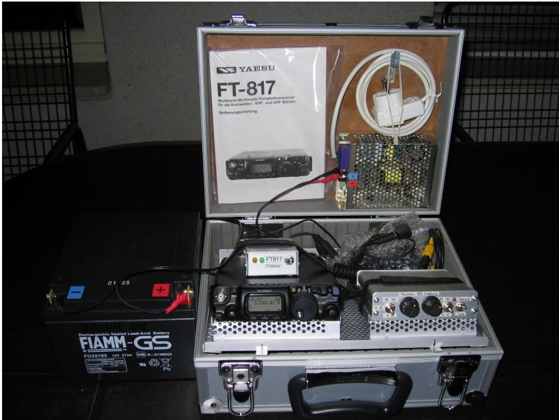
Mini-Notfunkkoffer im Akkubetrieb mit FT817 - ZM4 – und Spannungskonstanter betriebsbereit
