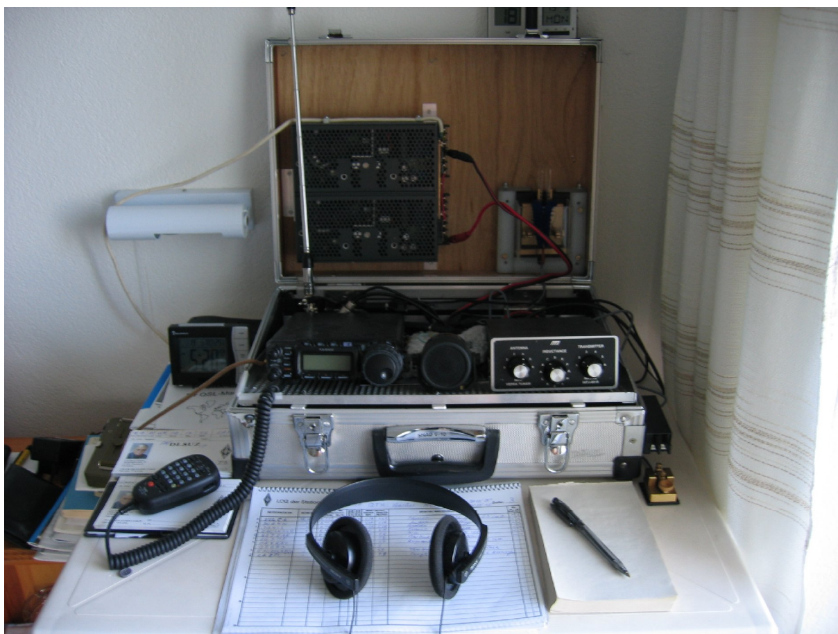
Notfunkkoffer mit YAESU FT 857 - Profi-Schaltnetzteil und MFJ- Antennenkoppler MFJ 901-B usw.
