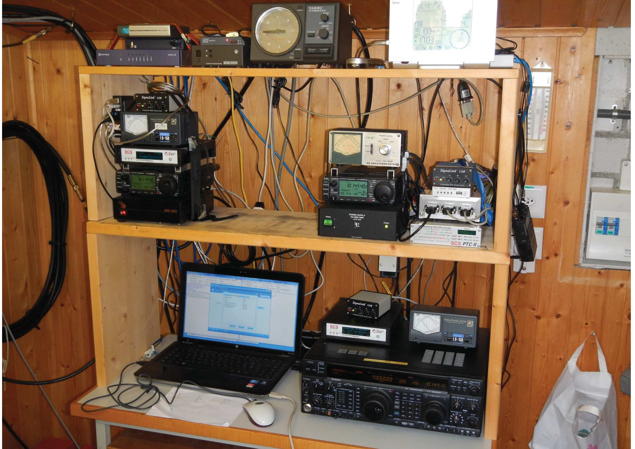
HB9AK mit Steuerungs-PC und den 3 TRX. Oben die Wetterstation für APRS
