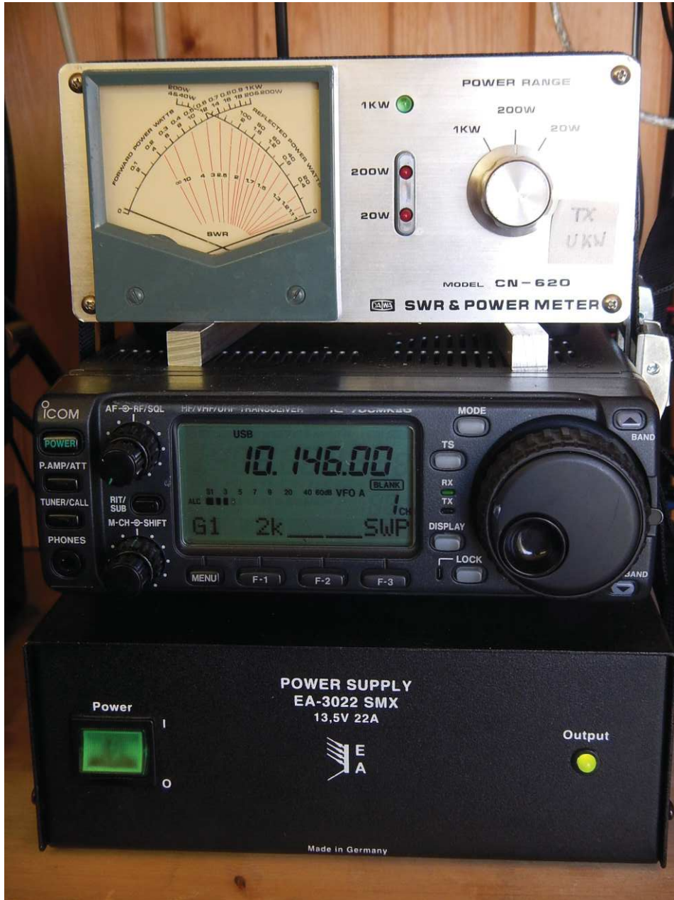
Die Ausrüstung für 30 m: TRX IC-706 mit PS und SWR Meter; rechts PTC-II, SignalLink, SCS Tracker
